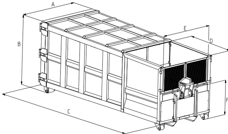
Abrollpresscontainer „DCS Draw Compacting System“, System für die Reduzierung und Pressung des Mülls mit KASSETTENPRESSE, ideal für Müll mit UNGETRENNTER TROCKENFRAKTION. Presscontainer im kompakten Design, entwickelt, um eine effiziente Dichtigkeit gegenüber Perkolat zu garantieren.
