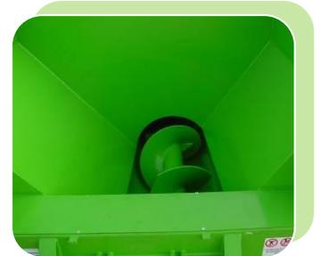
Durch eine doppelte Wirkung zerkleinert und präpariert das System das Material in der Pressphase, die bereits im Ladetrichter beginnt.
