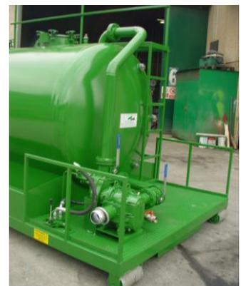
Abbildung 2- Detail der Umfüllpumpe
